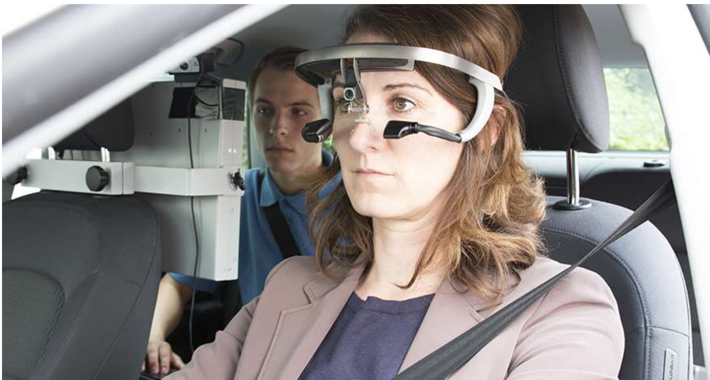
Abbildung 1: Ein Verrutschen der Blickerfassungsbrille während einer längeren Fahrt kann die Blickmessungen der gesamten Fahrt unbrauchbar machen, da im Blickvideo dadurch nicht mehr die tatsächlichen Blicke angezeigt werden. Ein Eye-Tracker mit Möglichkeit zur Nachkalibrierung (hier Dikablis von Ergoneers) kann diesen Fehler jedoch korrigieren und erhöht dadurch die interne Validität gemessener Blickdaten.
