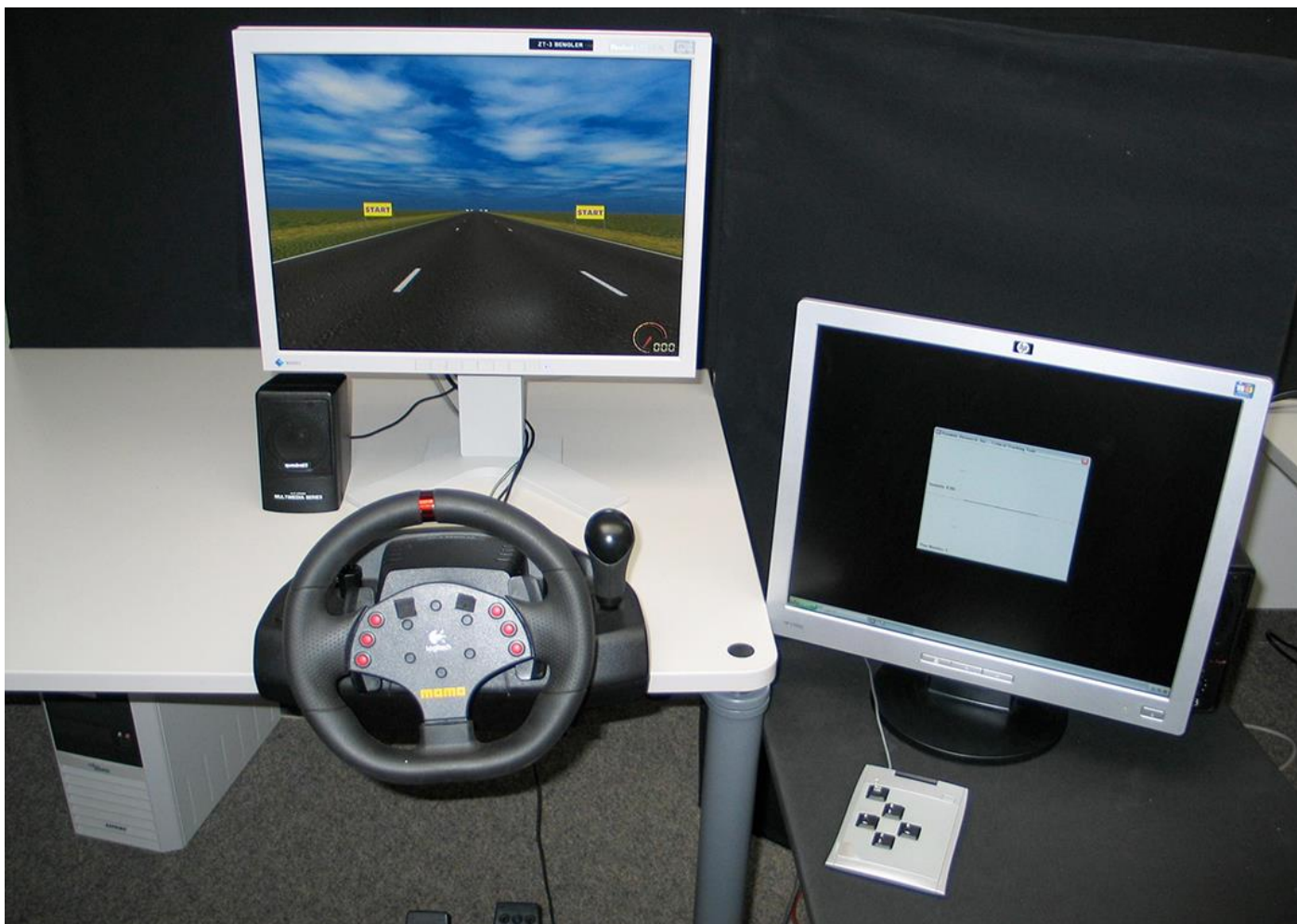
Abbildung 7: Die reduzierteste Form der Fahrsimulation: Ein simpler Tischaufbau mit Spielelenkrad und Spielepedalerie für die „Fahrzeugsteuerung“ sowie PC-Monitor für die Sichtsimulation. Auf dem zweiten Monitor rechts daneben wird die Nebenaufgabe dargestellt. Für Untersuchungen zum Lane Change Task ist dies eine typische Versuchsanordnung.
