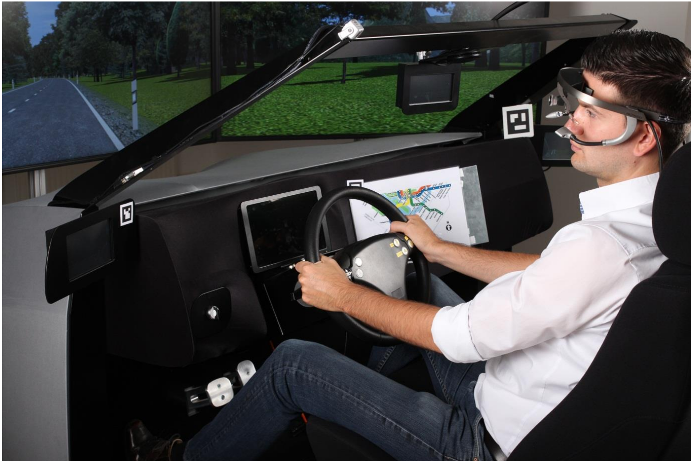
Abbildung 5: Ein einfacher, statischer Fahrsimulator, bei dem die Fahrumgebung auf drei großen Monitoren dargestellt wird.
