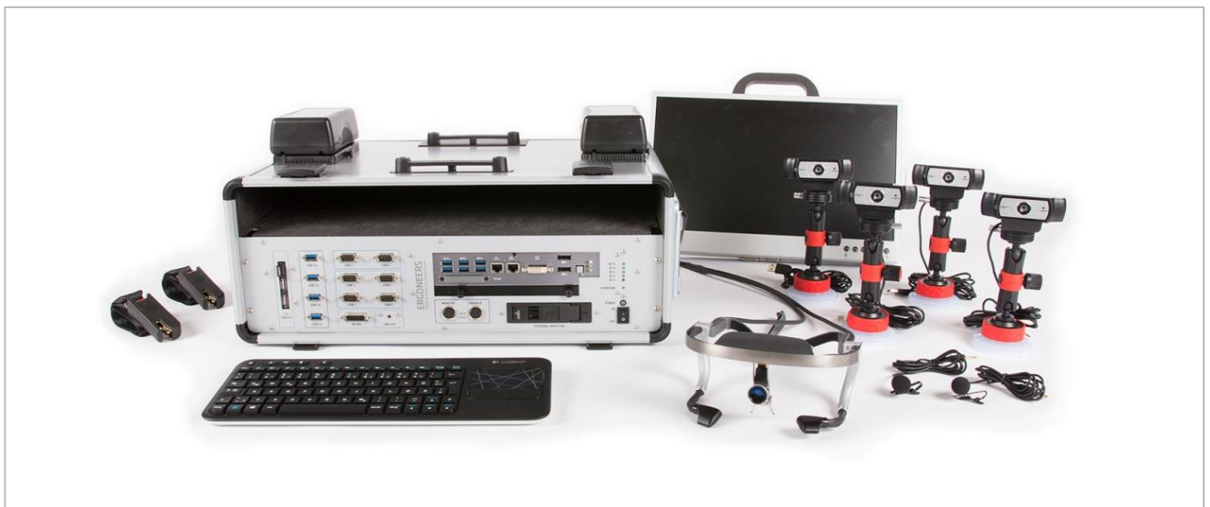
Abbildung 8: Für Fahrstudien im Realfahrzeug gibt es mittlerweile smarte Komplettlösungen, so dass ein Kofferraum voller Messtechnik der Vergangenheit angehört. Auch die Aufzeichnung von Blickdaten oder physiologischen Daten ist damit kein Problem. Das Bild zeigt das Vehicle Testing Kit (VTK) der Firma Ergoneers. Mehr ist für die Durchführung eines Realfahrtstudie nicht nötig – abgesehen von einem Auto.
