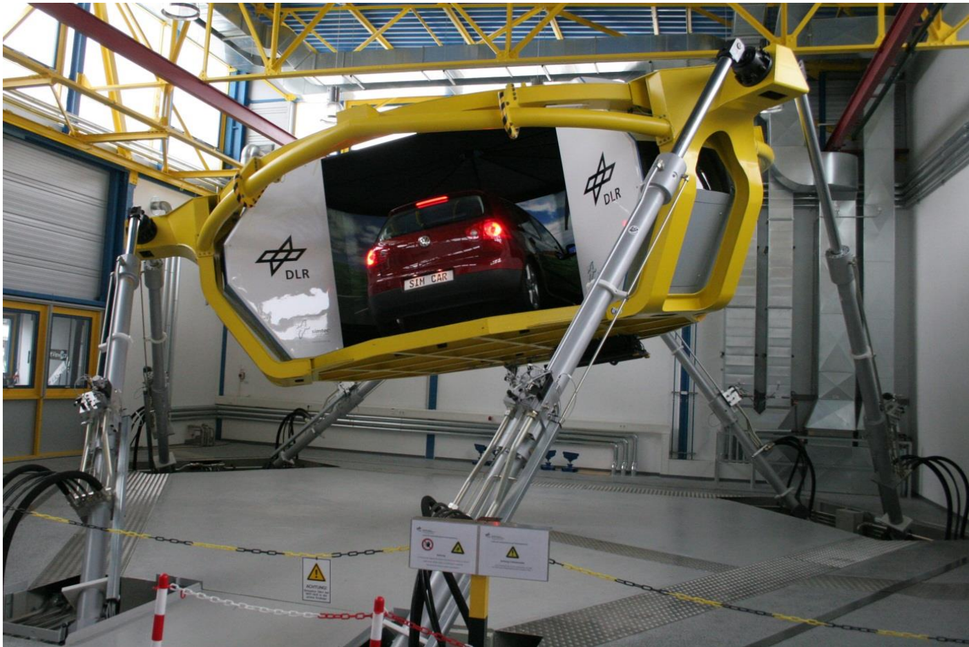
Abbildung 4: Bei einem hochwertigen Fahrsimulator (hier vom Deutschen Zentrum für Luft- und Raumfahrt, DLR) sitzt der Fahrer in einem echten Auto. Die virtuelle Fahrumwelt wird dabei rund um das Auto auf eine Leinwand projiziert. Der gesamte Aufbau ist auf sechs beweglichen Hydraulikstelzen (= Hexapod) gelagert, die durch Bewegung der gesamten Kabine typische beim Autofahren auftretende Vibrationen, Beschleunigungen und Fliehkräfte imitieren sollen. Bei manchen Versuchspersonen führt dies zu Übelkeit.
