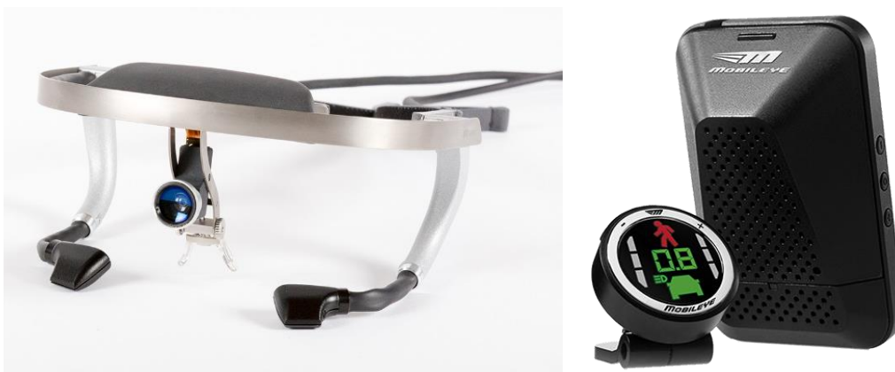
Abbildung 15 - Dikablis Professional Eye-Tracking-Brille (l.), Mobileye Fahrerassistenzsystem (r.)
