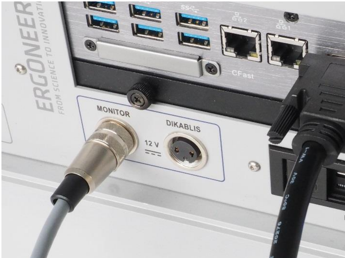
Abbildung 31 - Dikablis Stromanschluss am VTK
