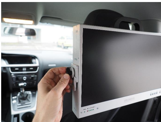
Abbildung 22 - Befestigung des Monitors an der montierten Kopfstützenhalterung
