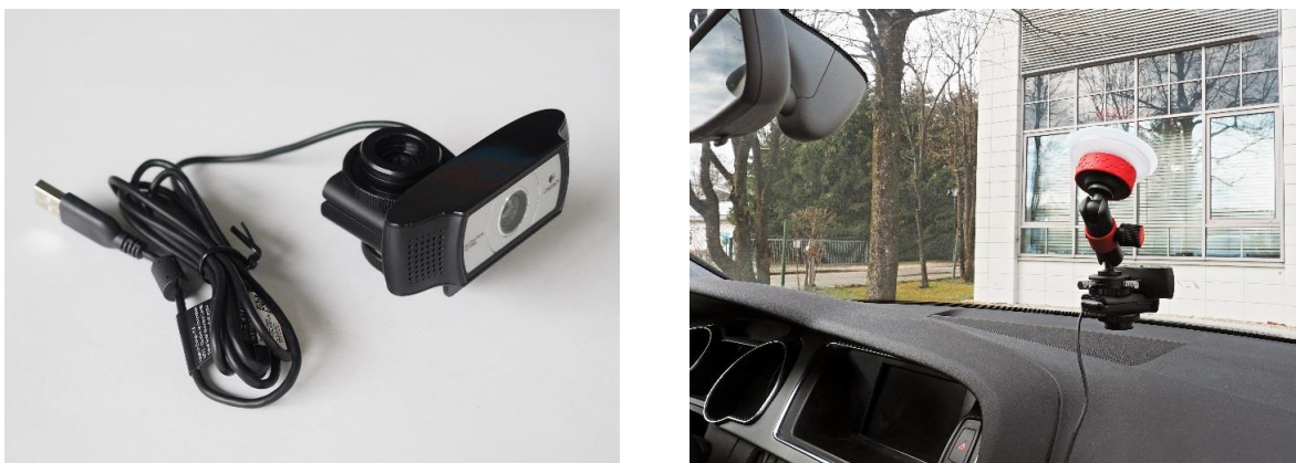
Abbildung 13 – Kamera mit zwei Schnellwechselplatten (l.) und Befestigung an der Frontscheibe (r.)
