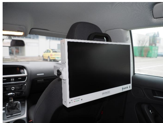
Abbildung 22 - Befestigung des Monitors an der montierten Kopfstützenhalterung
