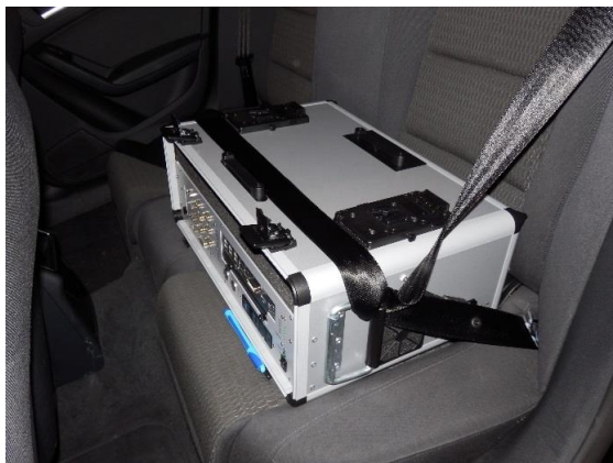
Abbildung 19 - Befestigung des VTK auf der Rücksitzbank mit Hilfe einer Gurtverlängerung
