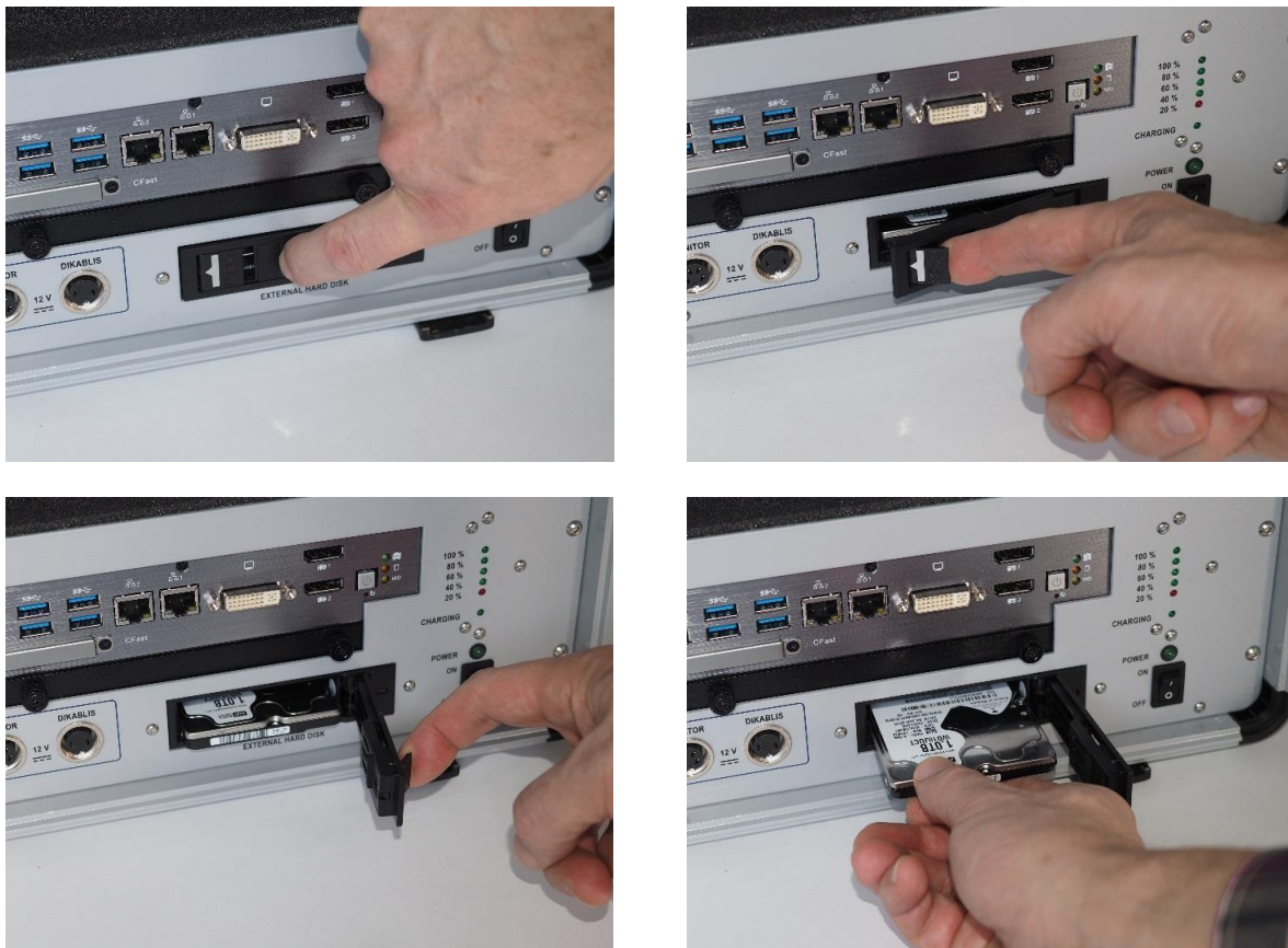
Abbildung 8 - Öffnen des Schubfachs und Entnahme der Wechselfestplatte
