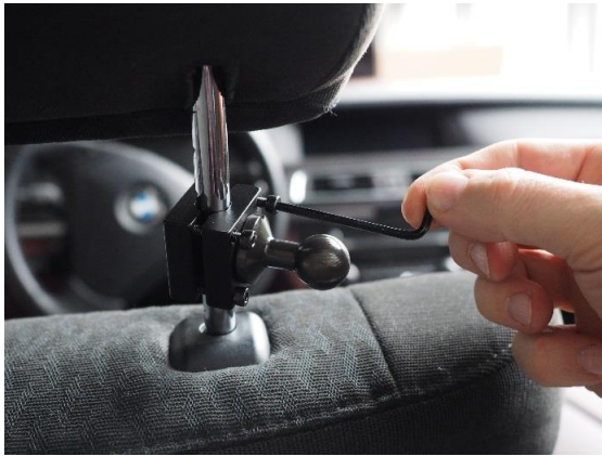
Abbildung 26 - Befestigung der Kugelkopf-Halterung am Gestänge der Kopfstütze
