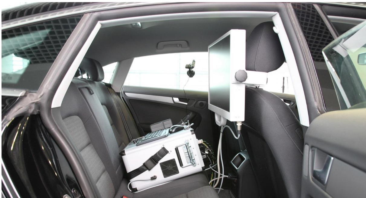
Abbildung 9 – Versuchsleiter-Platz auf der Rücksitzbank. Das VTK ist hinter dem Fahrer und der Monitor an der Kopfstütze des Beifahrersitzes befestigt.
