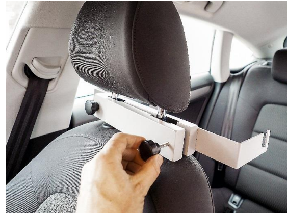
Abbildung 21 - Befestigung der Monitor-Halterung an der Kopfstütze
