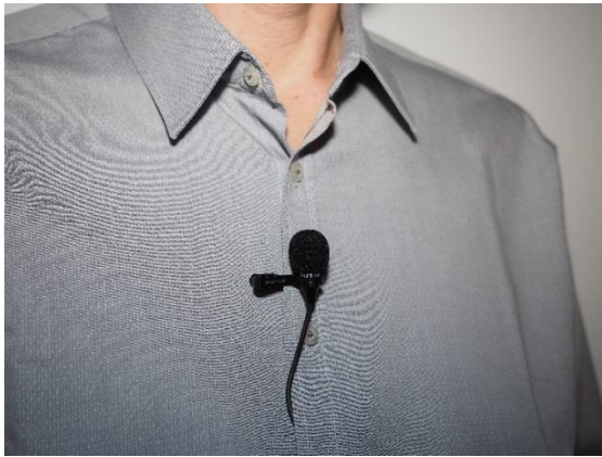
Abbildung 28 - Lavalier-Mikrofon .... Befestigung an der Knopfleiste
