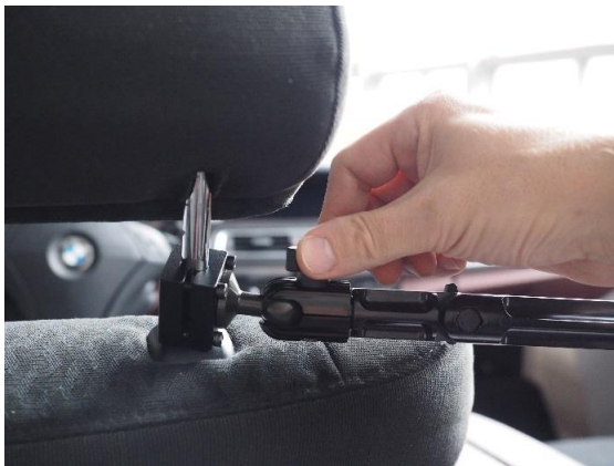
Abbildung 27 - Befestigung der Glieder am Kugelkopf und ihre Ausrichtung
