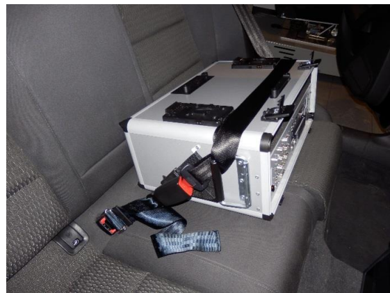
Abbildung 19 - Befestigung des VTK auf der Rücksitzbank mit Hilfe einer Gurtverlängerung
