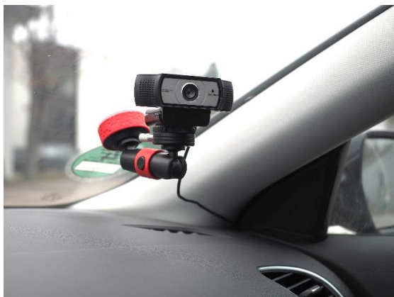
Abbildung 11 - Kamera .... auf einer Saugnapfhalterung
