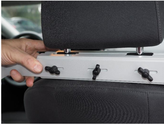
Abbildung 21 - Befestigung der Monitor-Halterung an der Kopfstütze
