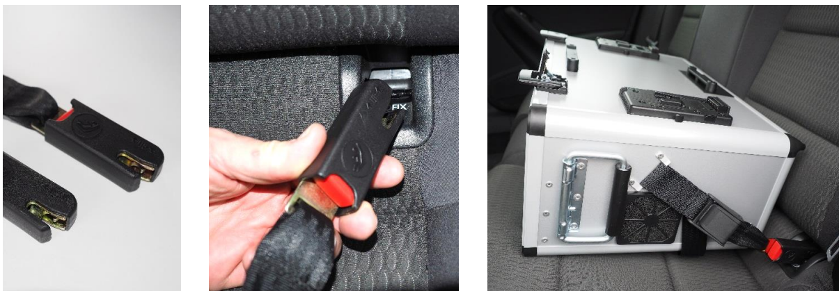
Abbildung 18 – Befestigung des VTK auf der Rücksitzbank mittels ISOFIX-Gurten
